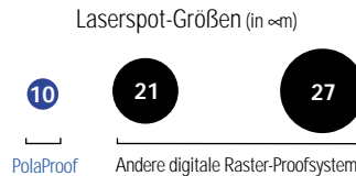
8) Vergrößerte Gegenüberstellung der Laserspot-Größen: Die nur 10 µm großen Laserspots des PolaProof-Systems ermöglichen eine höhere Ausgabequalität.
